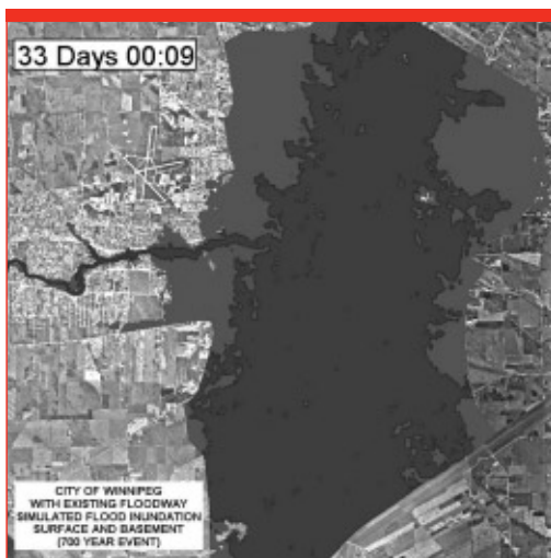
Impact des inondations sur les réseaux souterrains et de surface à Winnipeg dans le cas d'une inondation à récurrence de 700 ans avec le canal de dérivation existant.
